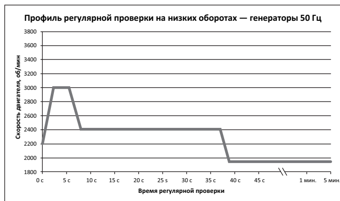
Рис. 3-7. Профиль регулярной проверки на низких оборотах
